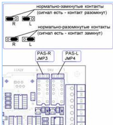
Ввод задаваемого режима осуществляется по соответствующим сигналам управления «L», «L-i» влево; «R», «R-i» вправо и «S» - сброс из системы. Управление осуществляется путем замыкания соответствующих контактов на общий провод контроллера.
